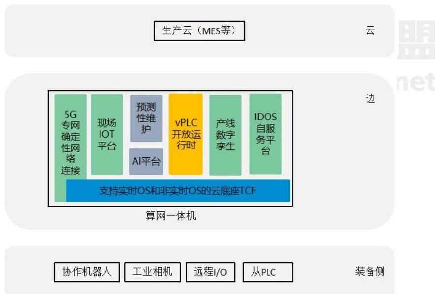
图A. 6.1 基于开放自动化系统的控制架构
