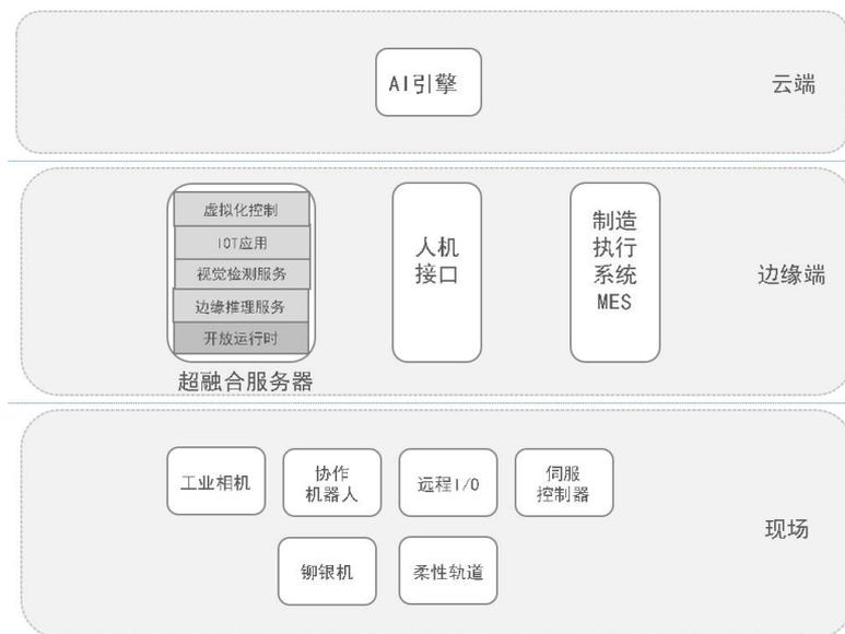
图A.1.1 基于开放自动化系统的控制架构
