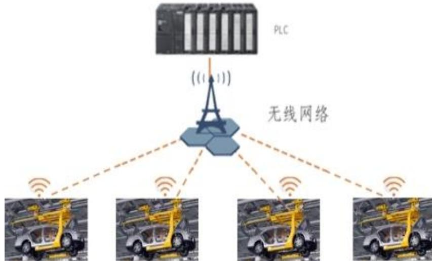
图 33 无线接入的 EMS 示意图
