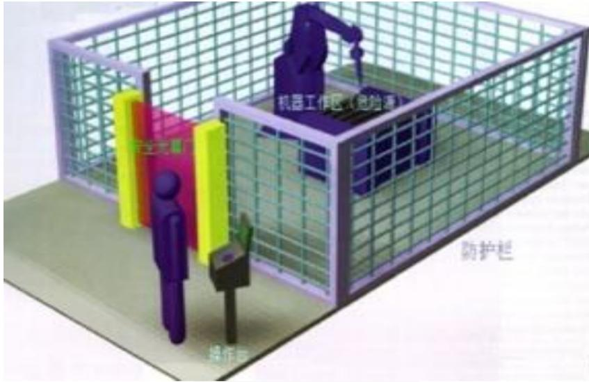
图 19 机器人工作区安全光栅示意图
