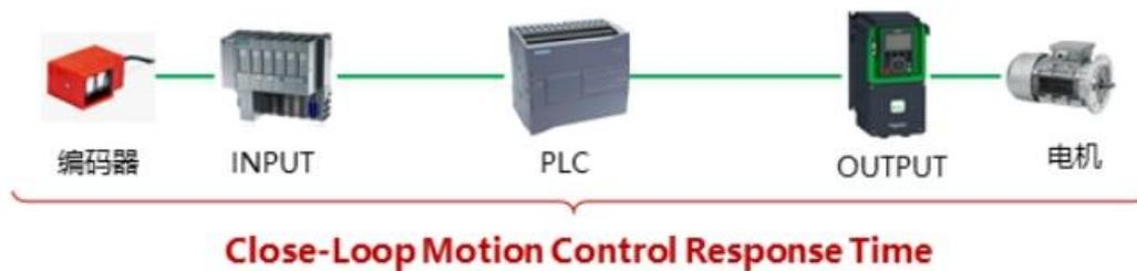
图 26 闭环运动控制响应时间示意图
