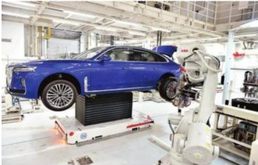
图 5 工艺 AGV 示意图
