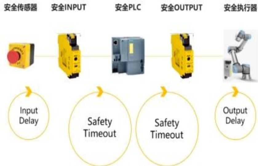
图 22 安全 SFRT 路径示意图
